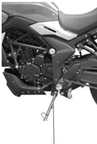
Cavalletto laterale abbassato
