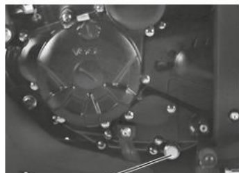
Vite di drenaggio
