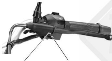
Vite di regolazione (1) Controdado (2) (sotto il manicotto in gomma)
